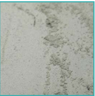
Quando riscado com um objeto de metal, o concreto não densificado se desgasta e se acumula facilmente. O concreto densificado e polido auxilia contra a erosão e o desgaste, mas não pode evitá-lo totalmente.
